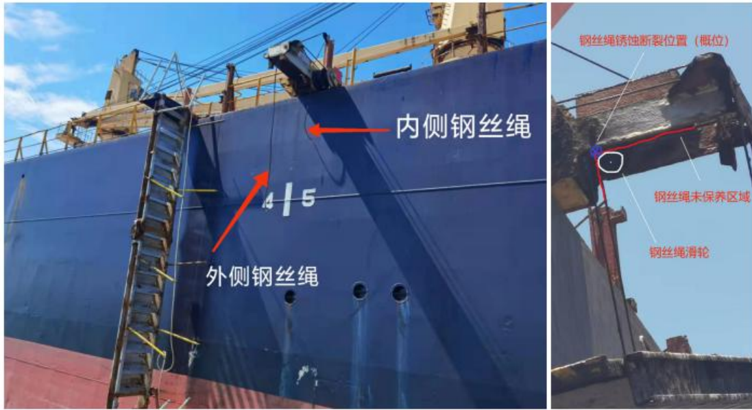
图 3：“华 XX2” 轮舷梯断裂钢丝绳示意图
