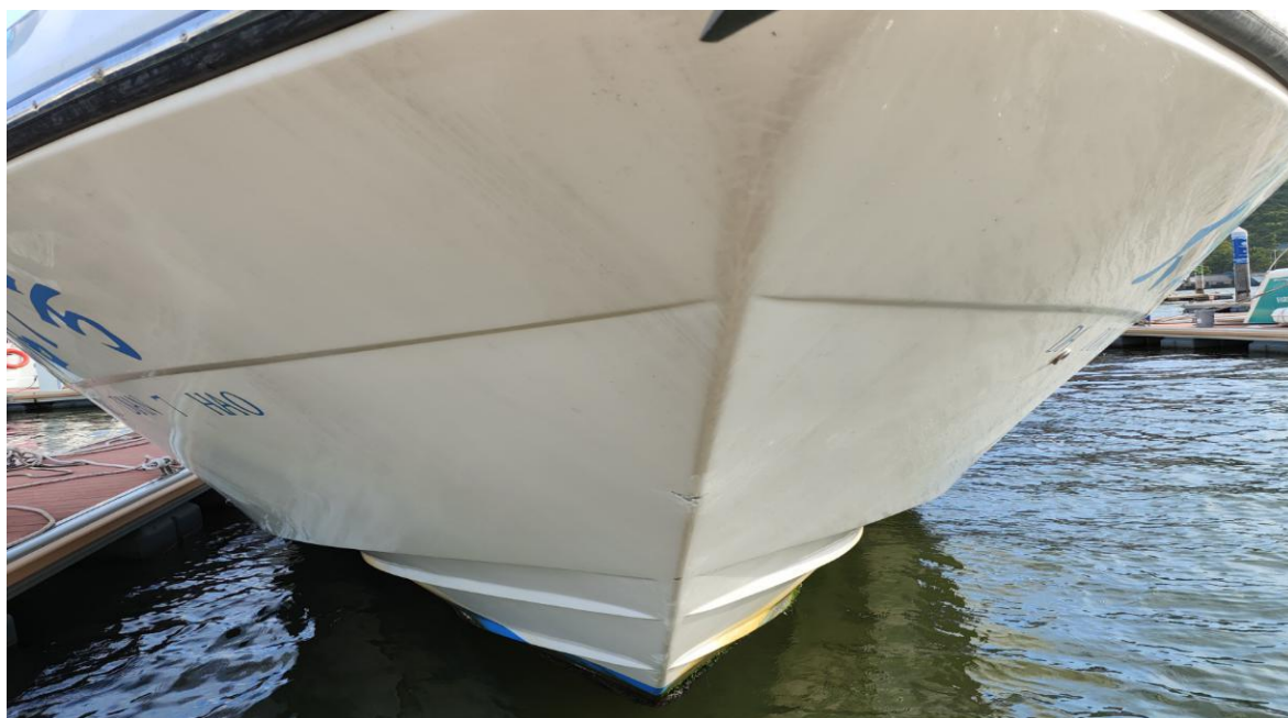
图 5：“大东海 XXX 号”游艇船艏尖部损坏照片（事后拍摄）
