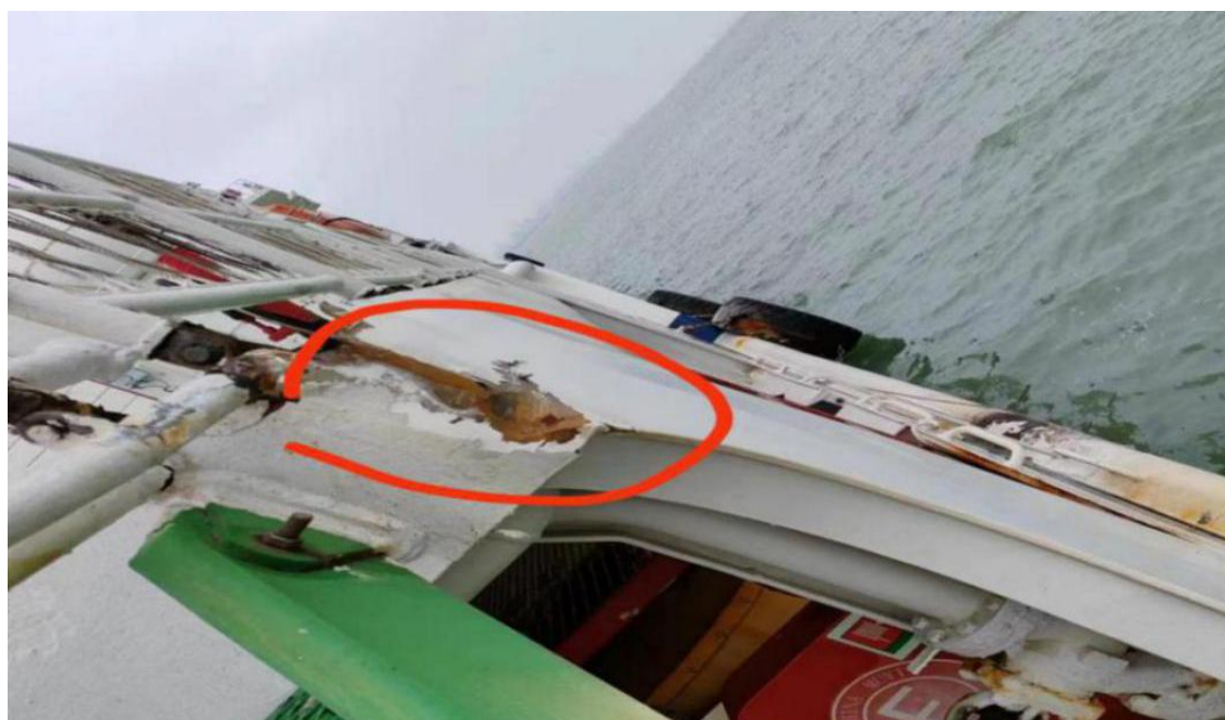
图8. “N” 轮左舷受损图
