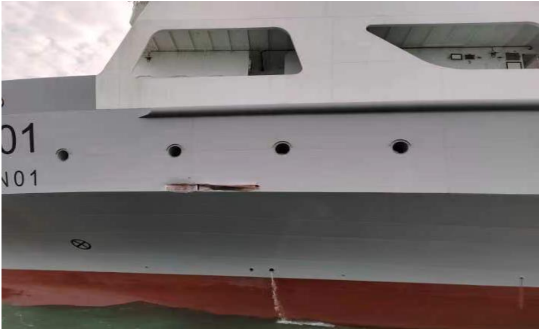
图11. “S” 轮左舷受损图
