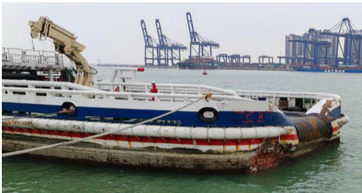
图7. “N” 轮船尾受损位置图
